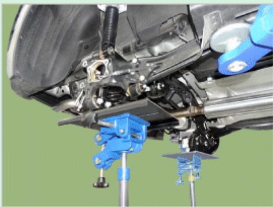
3. 拧下固定螺栓&螺母，并从副车架拆卸后辅助臂。
